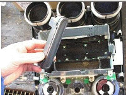
Die neue Blende für das MC-Modul in die frei gewordene Öffnung eindrücken. Beim CD-Modul einfach die Blende für das CD-Modul eindrücken.
