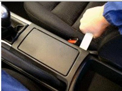
Als erstes wird mit einem Plastikkeil die hintere Handbremshebel-Konsole ausgehebelt. Diese ist nur gesteckt. Geht beim ersten Mal ein wenig schwer. Vielleicht mit einem kleinen Schraubendreher vorarbeiten, bis der Plastikkeil greift. **Vorsicht vor Kratzern !**
