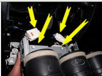
Jetzt die Kabel von hinten am Radiogerät abziehen. (Geht ein wenig schwer). Das Antennenkabel nicht vergessen. Dieses auch mit rausziehen.
