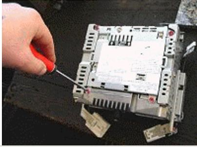
Das MC-Modul mit den im Lieferumfang befindlichen 4 Schrauben festziehen. (Auch Kinderleicht)
