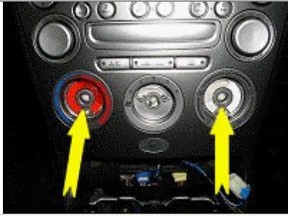
Bei **manueller Klimaanlage** die Knöpfe abziehen und hinter dem rechten und linkem Knopf die beiden Schrauben herausdrehen. Bei **automatischer Klimaanlage** entfällt dieser Schritt.
