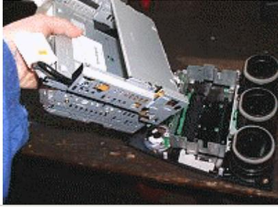
Jetzt kann man das Radiogerät von der Konsole trennen indem man es rauszieht.
