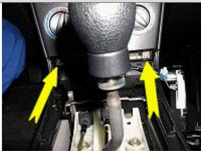
Die beiden Schrauben der Mittelkonsole rausdrehen.
