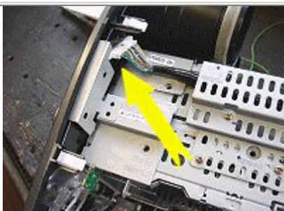
Stecker abziehen. Dazu den am Stecker befindlichen Plastikclip runterdrücken und Stecker abziehen.
