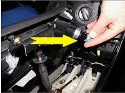
Kabel vom Zigarrenanzünder von hinten trennen. Kabel von Beleuchtung ebenfalls trennen (geht ein wenig schwer). Konsole jetzt abnehmen.
