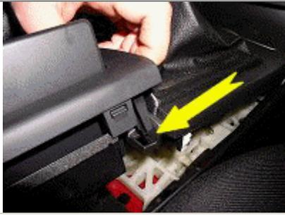
Die hintere Konsole (Handbremse) von der vorderen Konsole (Schalthebel) lösen. Dazu von unten mit dem Finger die Nase der Verbindungsclipse reindrücken und die Konsole nach oben ziehen. Rechte Seite und linke Seite.
