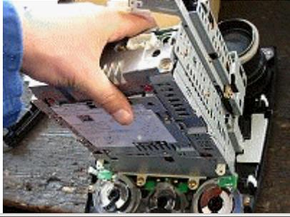
Jetzt das Radiogerät mit dem, in diesem Fall eingestecktem MC-Modul, wieder in die Konsole von hinten einschieben. Die 4 Schrauben rechts und links wieder reindreihen. Das zuvor abgetrennte Kabel wieder reinstecken.
