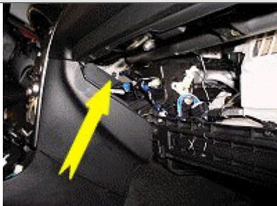
10er Schraube hinter dem Handschuhfach am Radiogerät herausdrehen.
