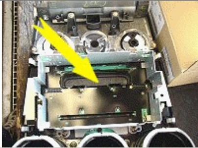
Jetzt zurück zur Konsole. Die Abdeckung nach oben ziehen. Dann haben Sie diese schon in der Hand. Beim CD-Modul einfach diese Blende nach oben ziehen. (Ist logischerweise die kleinere schmale Abdeckung).
