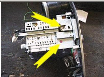
Konsole auf einem Tisch legen und rechts und links die beiden Schrauben rausdrehen. (Zusammen 4 Schrauben)
