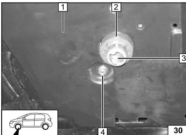
Abgasendstück 3 und Profilmgummi rot 2 gem. Bild ausrichten, dabei Profilmgummi rot 2 mittig in Bohrung vom Unterfahrschutz 1 positionieren!
