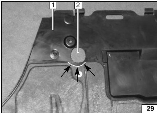
Dämmung an der Markierung wegschneiden!
